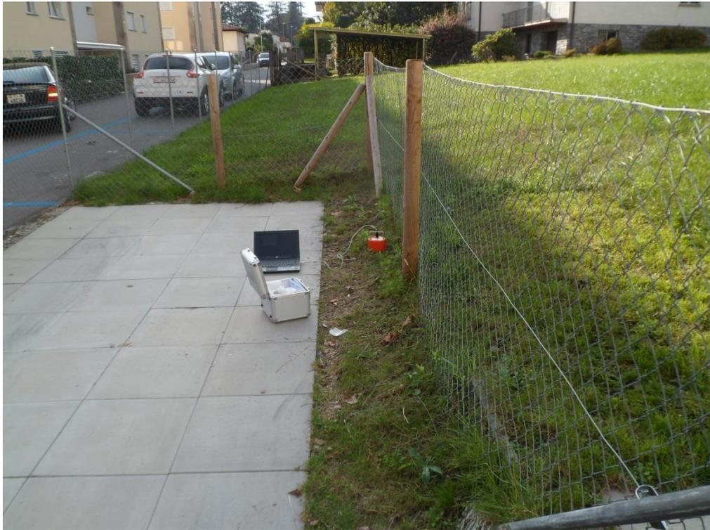
Istallazione di misura per la sismica passiva
